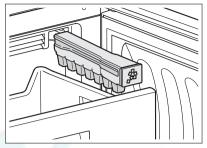
Снимите заглушку. Налейте воду до отметки "МАХ".
