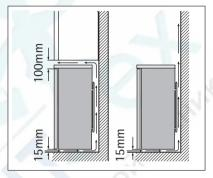
ливать прибор под навесной мебелью. Точная установка по уровню достигается с помощью регулировки одной или нескольких регулировочных ножек, расположенных в основании корпуса. При установке устройства в углу дверными петлями к стене расстояние между боковой стеной и устройством должно быть не менее 10 мм, чтобы дверца открывалась достаточно широко для извлечения полок.
